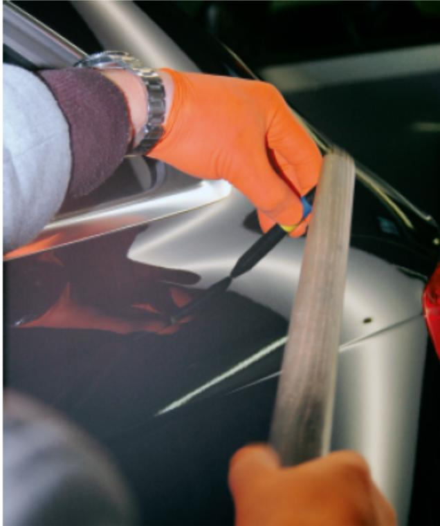
**Finish:** Verbleibende Restspannungen im Material löst der Dellenspezialist durch leichte Schläge mit einem Teflonstift und Hammerstiel.
