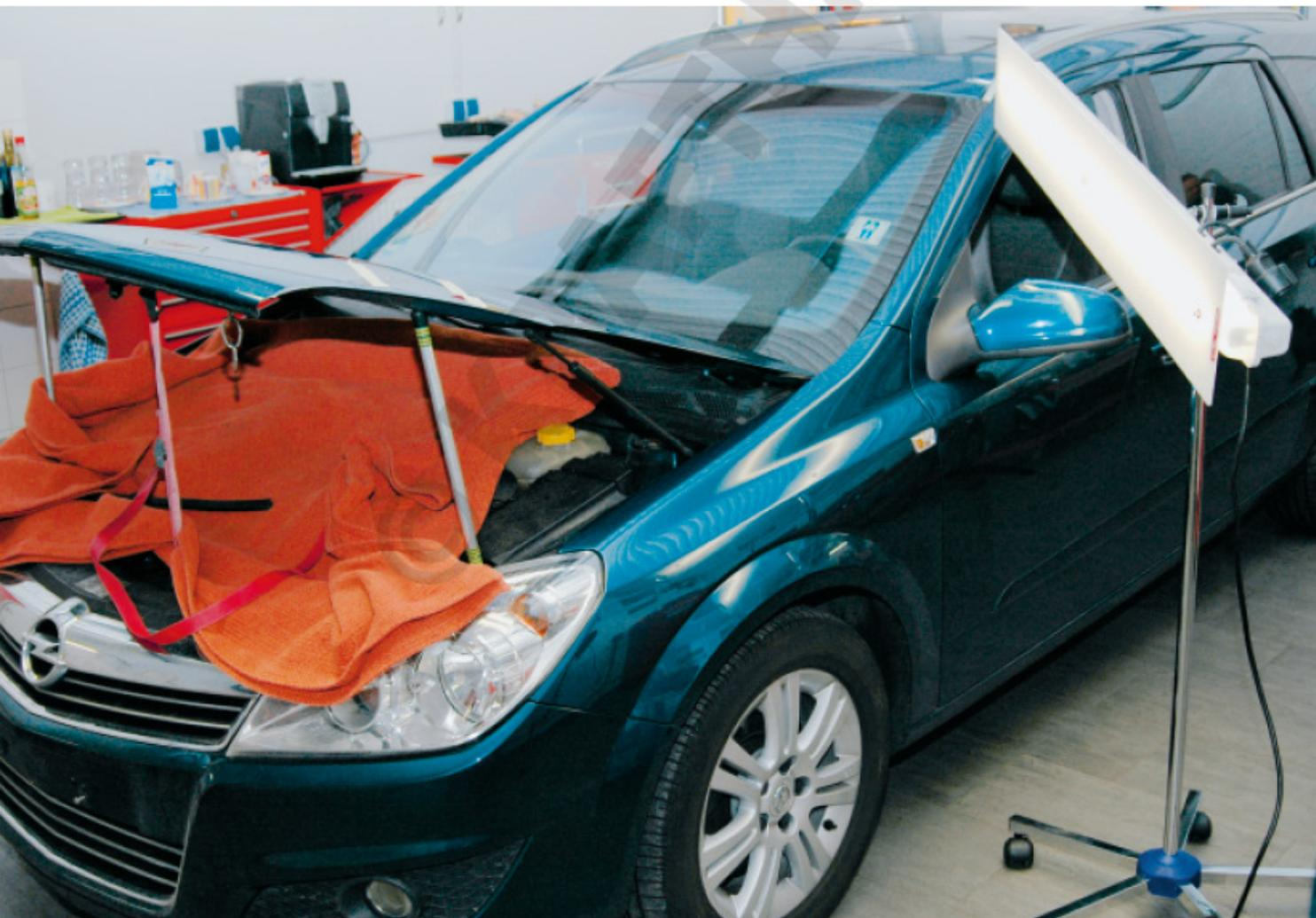
**Expertenwissen:** Bei Müller Dellentechnik werden die Kursteilnehmer an modernen und aktuellen Fahrzeugmodellen geschult. Vor dem Drücken beispielsweise einer Motorhaube wird diese zuvor mit den Verzurrteilen befestigt. Bilder: Guranti
